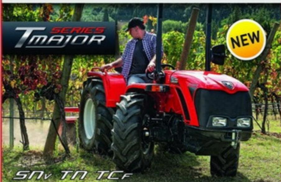
La nuova Serie T Major si compone di mezzi a telaio sterzante o articolato; a ruote isodiametriche o posteriori maggiorate. La perfetta ripartizione dei pesi sulle quattro ruote motrici, assicura aderenza, stabilità e sicurezza. La serie T Major si distingue con i modelli SNv, TN e TCF con di potenze di 49,7 e 56 CV.
